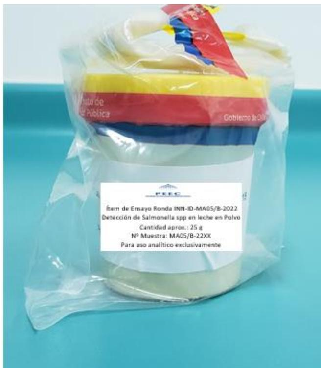
El material de ensayo fue distribuido a los participantes de manera simultánea, bajo condiciones de congelación, en un envase secundario correspondiente a un estuche aluminizado para cadena de frío, dentro de un envase terciario de poliestireno expandido (EPS) de manera de asegurar su conservación para el fin previsto.
